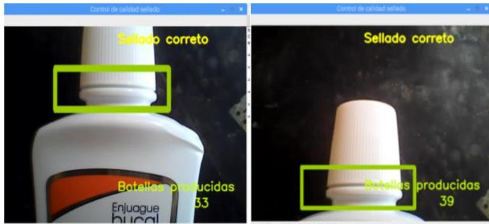
Diferencias en el sistema de vision artificial (izquierda: frasco de 500ml, derecha: frasco de 300ml).
