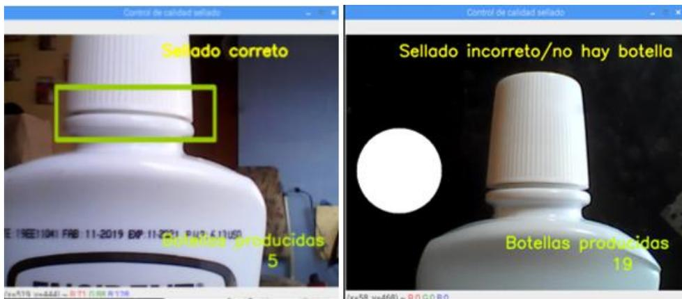
Resultado final sistema de visión artificial bien sellado (izquierda), Mal sellado (derecha). Elaborado por: Marlon Lastra y Brayan Salazar
