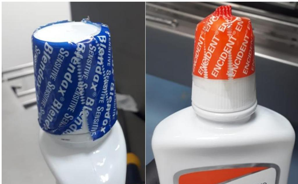
Capuchón mal termo encogido por exceso de temperatura, (izquierda: desprendimiento línea de seguridad, derecha: levantamiento por efecto de la temperatura del aro). Elaborado por: Marlon Lastra y Brayán Salazar
