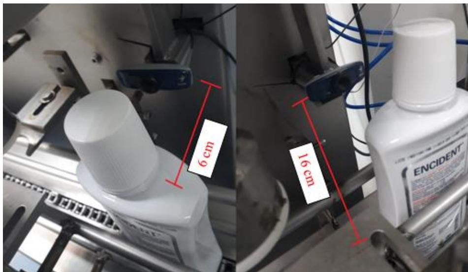
Camara y medidas ocupadas para el sistema de vision artificial instalados en BLENASTOR C.A.
