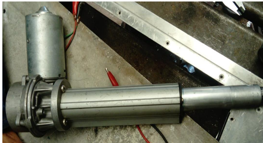
Actuador lineal de 24 V. Fuente: (Autores, 2019)
