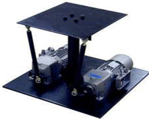
Figura 3. 2 Plataformas de estabilidad con 2 ejes
