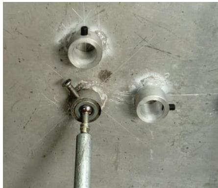
Fijación de la base del soporte central a la plataforma. Fuente: (Autores, 2019)
