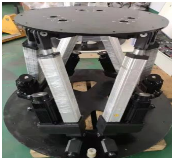
Figura 3. 1 Plataformas de estabilidad con 6 ejes
