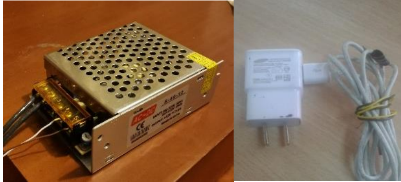
Figura 3.8 Fuente variable de \pm 12 V y Fuente de 5 V. Elaborado por: Cristóbal Caizaluiza, David Yáñez.
