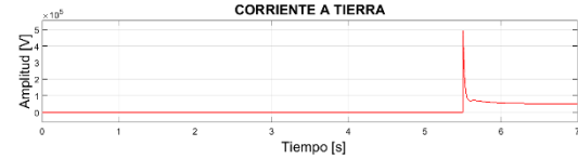
Figura 28. Corriente a Tierra caso 1
