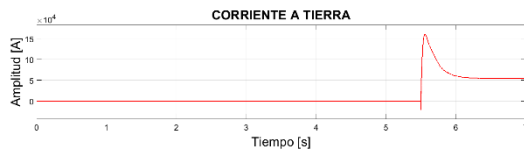
Figura 34. Corriente a tierra caso 2
