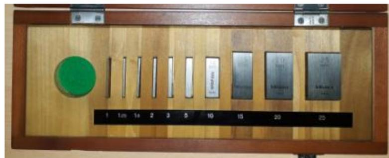
Figura 47. Bloques patrones de calibración
