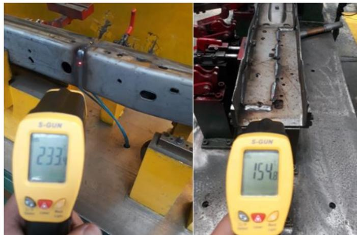
Figura 23. Temperatura de rieles al terminar la soldadura
