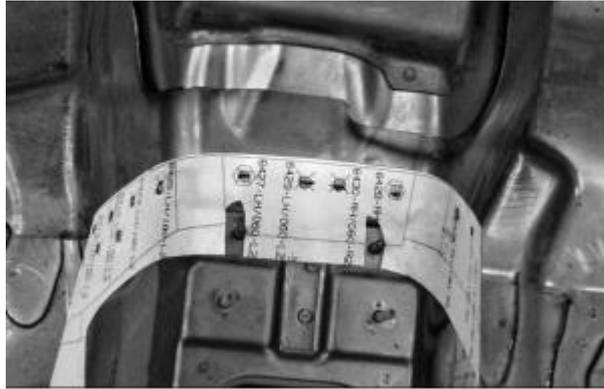
Figura 36. Plantilla de soldadura [15]
