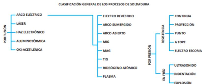
Figura 2. Clasificación general de los procesos de soldadura [11]
