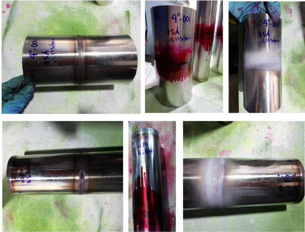
Figura 22. Inspección visual y de tinta soldadura manual, informe técnico
