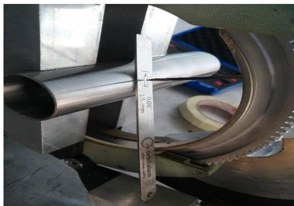
Figura 16. Galga y electrodo de tungsteno de punta morada, Gamarra (2020)
