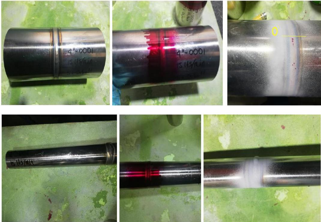
Figura 21. Inspección visual y de inyección de tinta soldadura orbital, informe técnico
