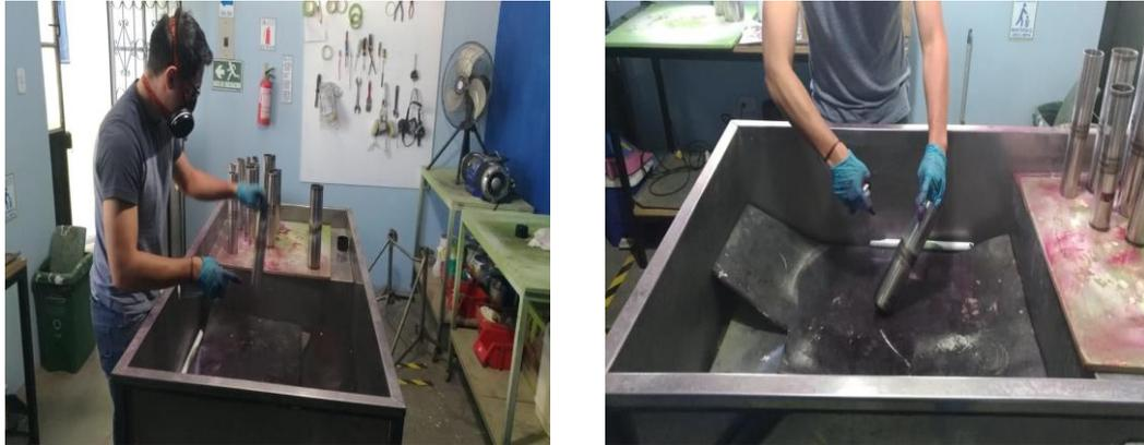
Figura 20. Prueba de ensayos no destructivos, visual e inyección de tinta, Gamarra (2020)
