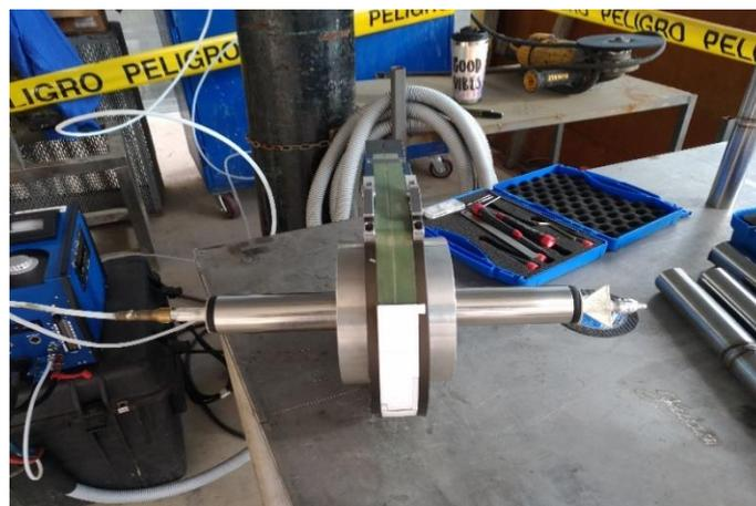
Figura 18. Inyección de argón en el orbital para el proceso de soldadura, Gamarra (2020)
