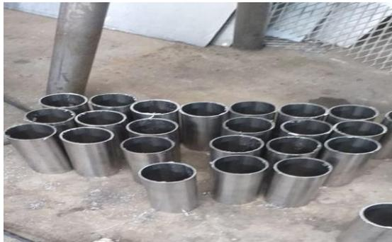
Figura 14. Probetas culminadas para soldadura TIG y posterior prueba de ensayos no destructivos, Gamarra (2020)
