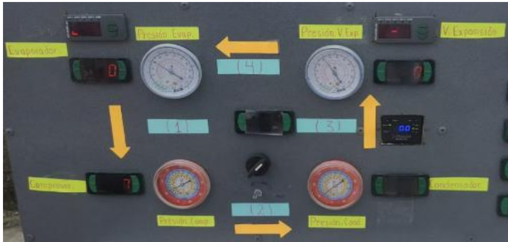
Figura A. 7. Controladores PID de temperaturas y manómetros de alta y baja presión. Elaborado por: Henry Delgado y Diego Recalde
