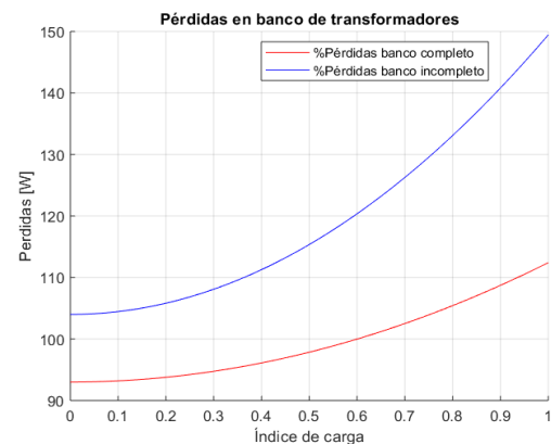
Figura 11. Pérdidas producidas por un banco completo e incompleto por una carga trifásica de 12 [kVA].
