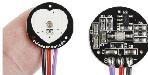
Figura 12. Sensor para medir la frecuencia cardíaca
