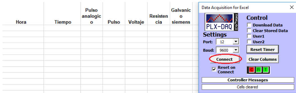
Figura 81. Conexión del plugin PLX-DAQ para Arduino para verificar la transmisión
