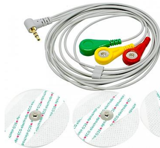
Figura 11. Electrodo empleado para medir la señal de GSR
