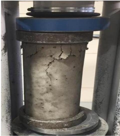
**Figura 3.** Espécimen de hormigón simple ensayado a compresión simple.
