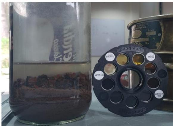
Figura 6. Comparación entre el colorímetro normado en el ASTM C-40 y el ensayo de esta investigación
