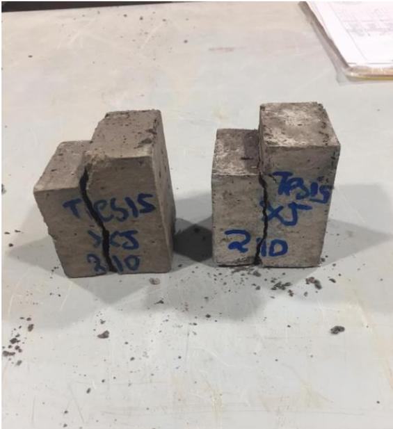
Ensayo a corte de la muestra tipo 1
