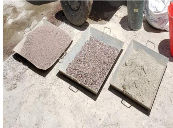
Figura 1. Agregados gruesos – fino, cemento
