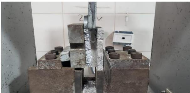
**Figura 5.** Adaptación del ensayo de la resistencia al corte según la normativa ASTM D-143
