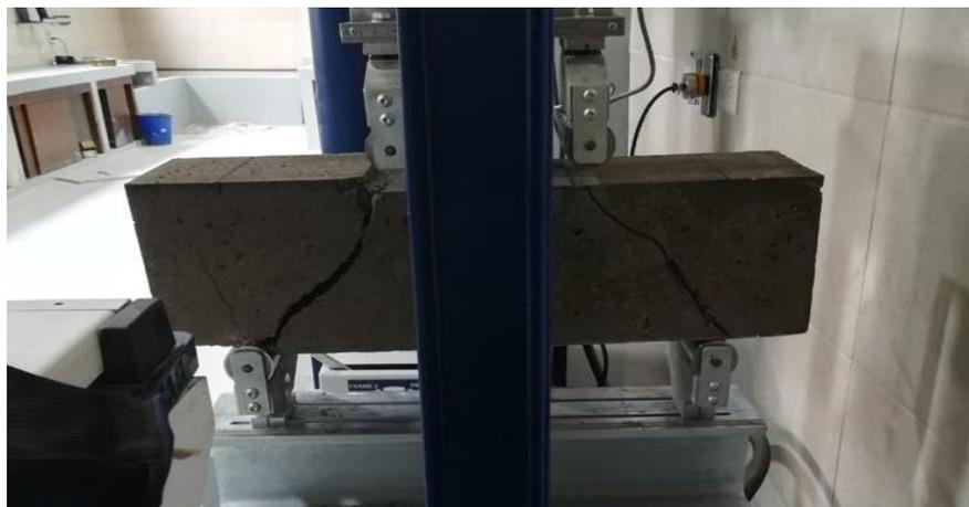
Ensayo a corte de la muestra tipo 3
