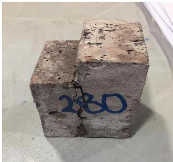
Ensayo a corte de la muestra tipo 1
