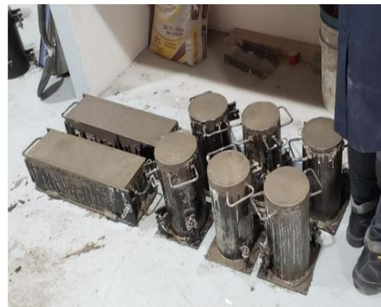
Figura 4. Cilindros y vigas de hormigón.
