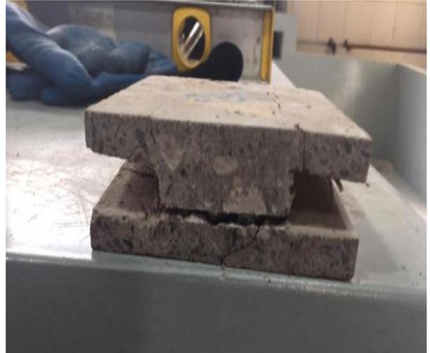
Ensayo a corte de la muestra tipo 2
