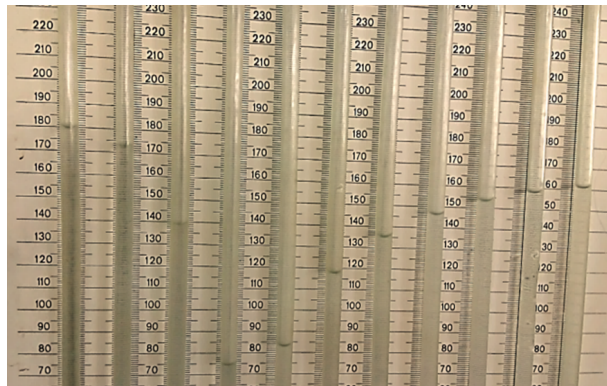
Figura 7. Alturas piezométricas para diferentes niveles de las columnas de agua, correspondiente al experimento 3.
