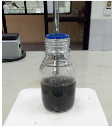
Figura 12. Titulación con tiosulfato de sodio 0,1 N para la determinación del índice de yodo
