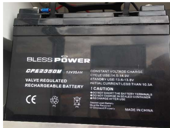
Figura 45. Batería Bless Power. Fuente: Autores
