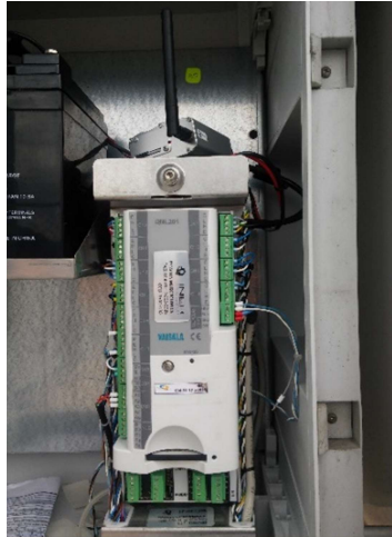
Figura 38. Sistema Hidrometeorológico MAWS110CP. Fuente: Autores
