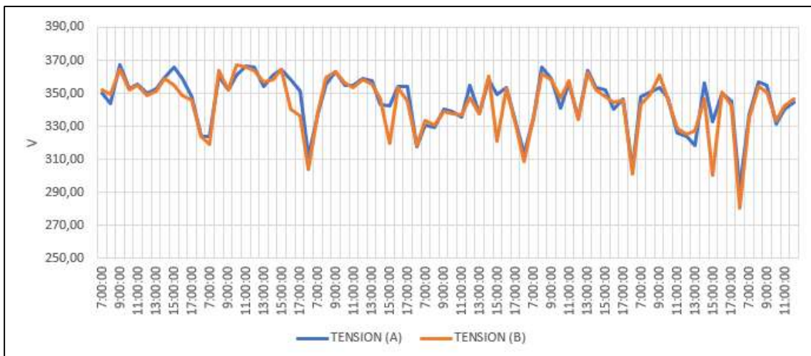
Figura 32. Tensión C.C. de los paneles monocristalinos medida. Fuente: Autores
