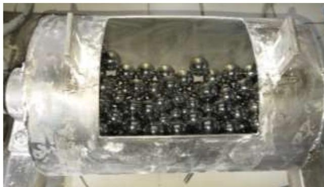
Figura 30: Material moliente Bolas. Fuente: Autores
