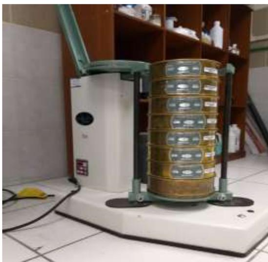
*Figura 13: Agitador automático Advantech Dura Tap. Fuente Autores*
