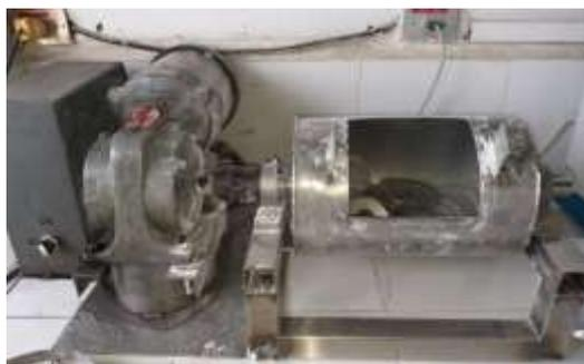
Figura 10: Molino horizontal giratorio. Fuente: Autores.
