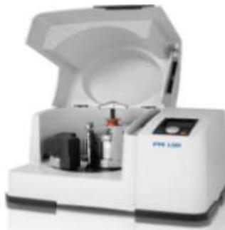
Figura 3: Molino de bolas planetario [2]
