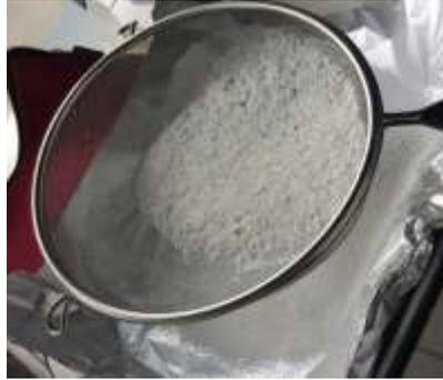
Figura 26: Homogenización de la muestra. Fuente: Autores
