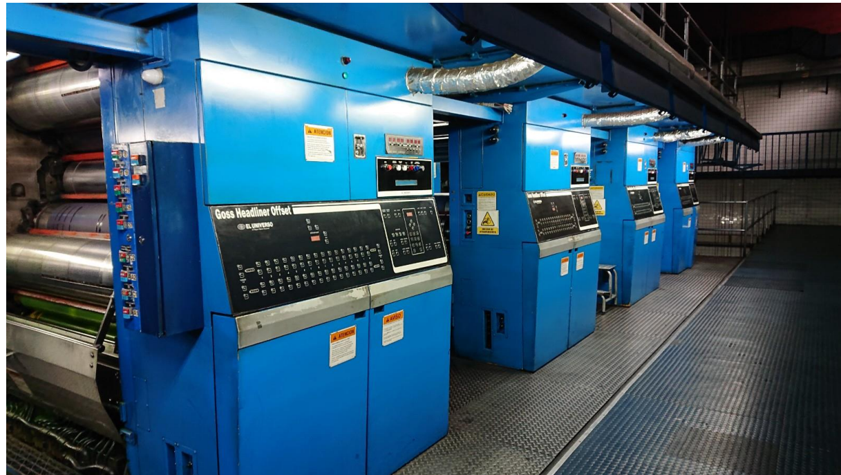
Área de unidades RTP GOSS para montaje de las bobinas de papel
