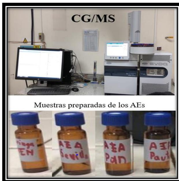
*Ilustración 6* Equipo de cromatografía de gases acoplado a masas y muestras preparadas de los AEs.
