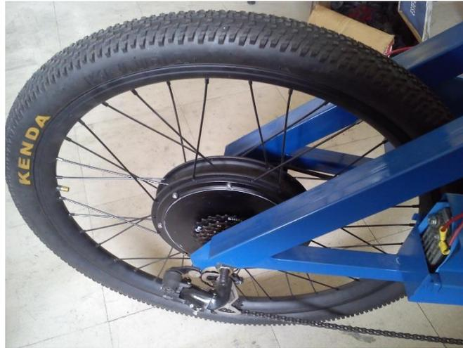
Figura 3-15. Motor eléctrico incorporado al Trike Bike Híbrido.
