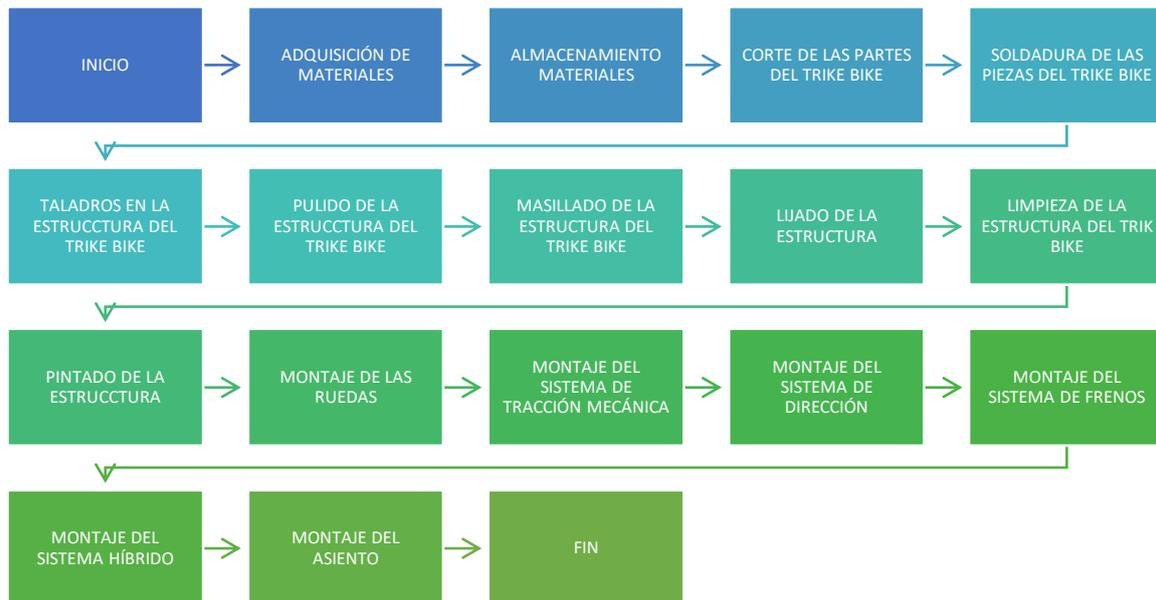
Figura 3-1. Secuencia de pasos a seguir en la construcción del Trike Bike Híbrido.
