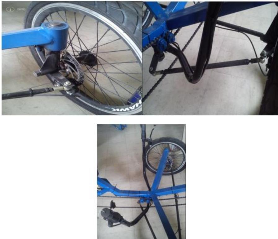
Figura 3-11. Montaje del sistema de dirección en la estructura del Trike Bike.Híbrido
