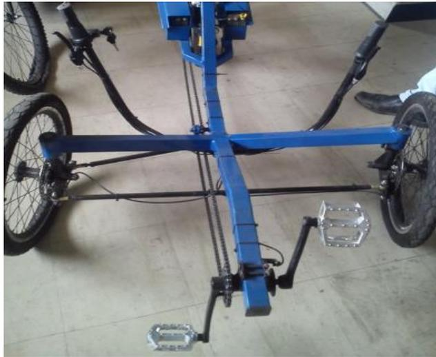
Figura 3-12. Sistema de frenos montados en el Trike Bike.
