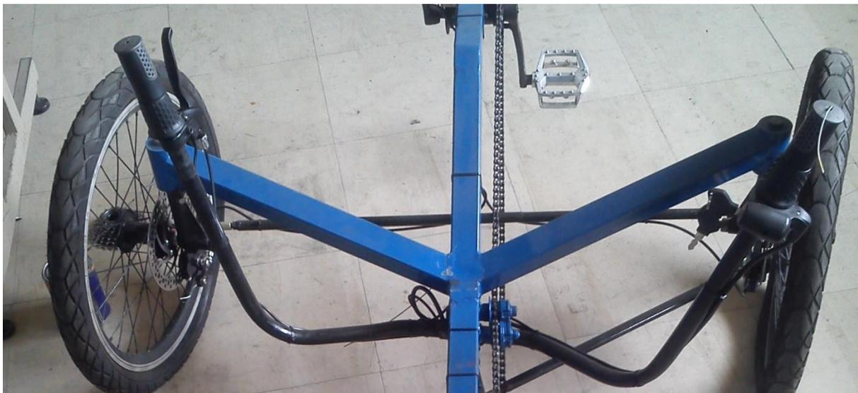
Figura 3-19. Maniquete de aceleración y manijas de frenos incorporados al Trike Bike Híbrido.
