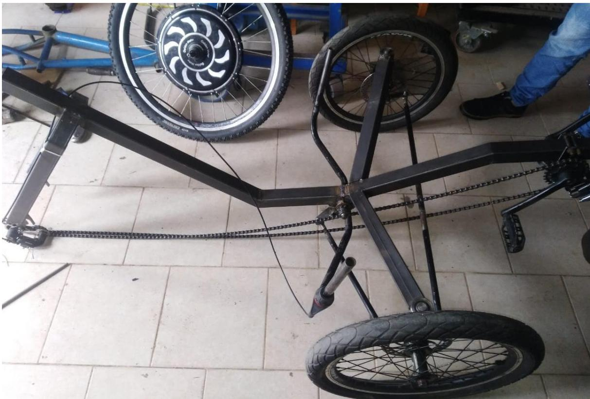
Figura 3-5. Estructura completa del Trike Bike Híbrido.
