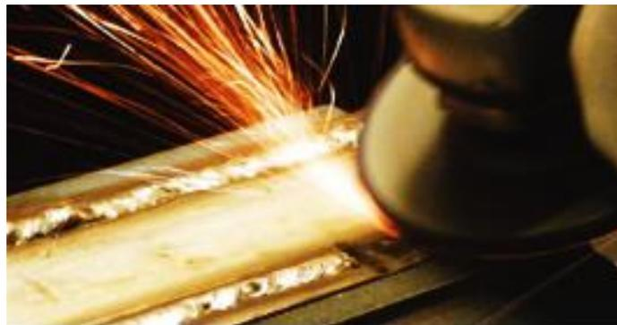
*Figura 3-6. Pulido de piezas con soldadura.*
