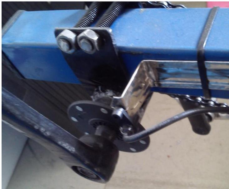
Figura 3-21. Sensor de pedaleo Montado a la estructura.
