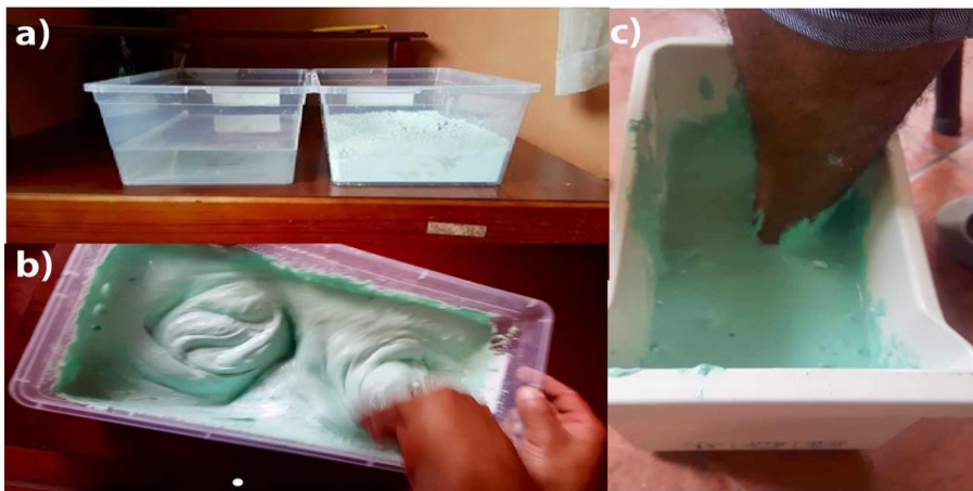
Figura 19. a) Proporción de agua y alginato. b) Mezcla homogénea de los dos componentes y c) Pie introducido en el producto.
