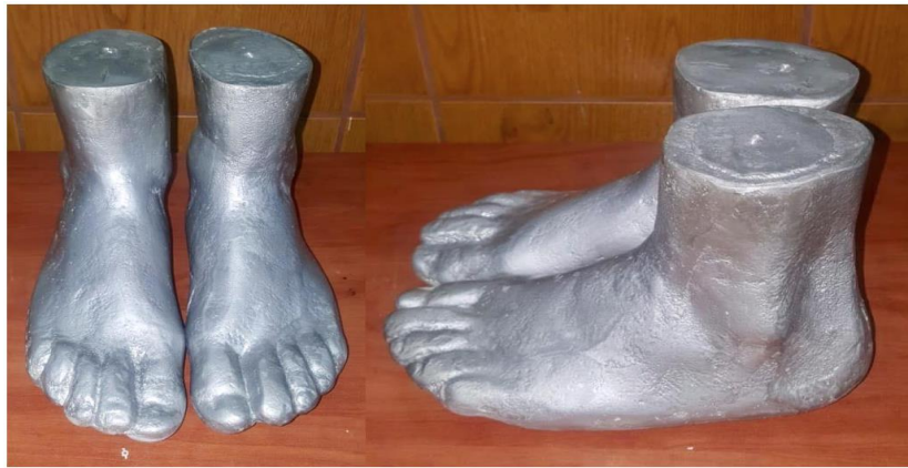
Figura 21. Vista frontal y lateral de los moldes fundidos en aluminio.
