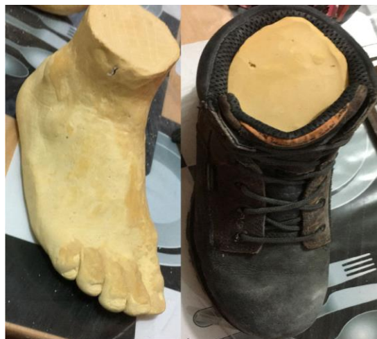
Figura 20. Verificación de la talla del molde en un calzado Timberland Pro.
