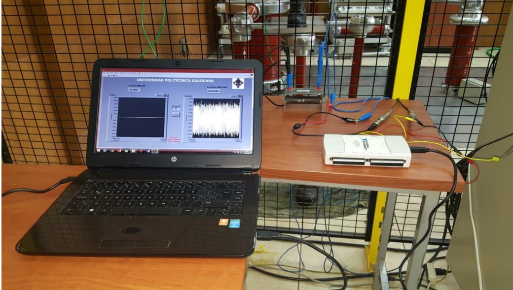
Figura 18. Sistema de adquisición de datos y entorno gráfico en LabVIEW para el procesamiento de información.
