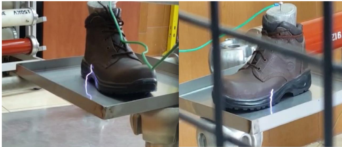
Figura 114. a) Calzado nuevo derecho descarga por arco eléctrico b) Calzado nuevo izquierdo descarga por arco eléctrico.
