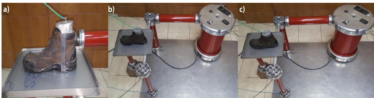
Figura 55. Ensayo Condiciones Húmedas: a) Medida del agua b) Calzado dado de baja Derecho c) Calzado dado de baja Izquierdo.
