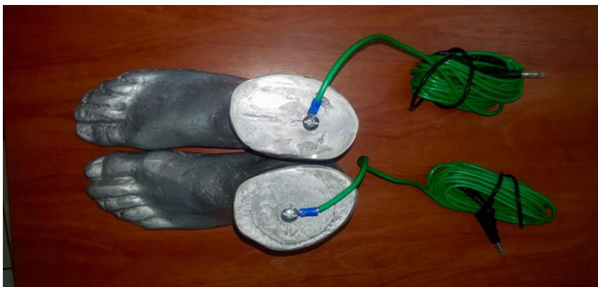
Figura 22. Conexión del perno tipo ojo en la parte posterior del pie.
