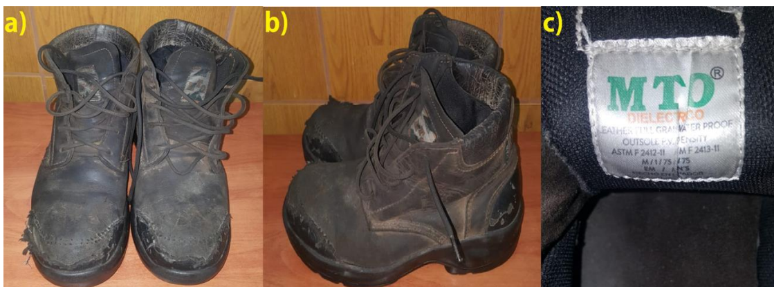
Figura 27. Calzado dieléctrico dado de baja MTO: a) Vista frontal, b) Vista lateral y c) Etiqueta ASTM.
