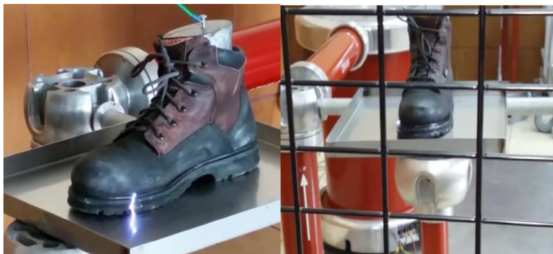
Figura 115. a) Calzado medio uso derecho descarga por arco eléctrico b) Calzado medio uso izquierdo descarga por arco eléctrico.
