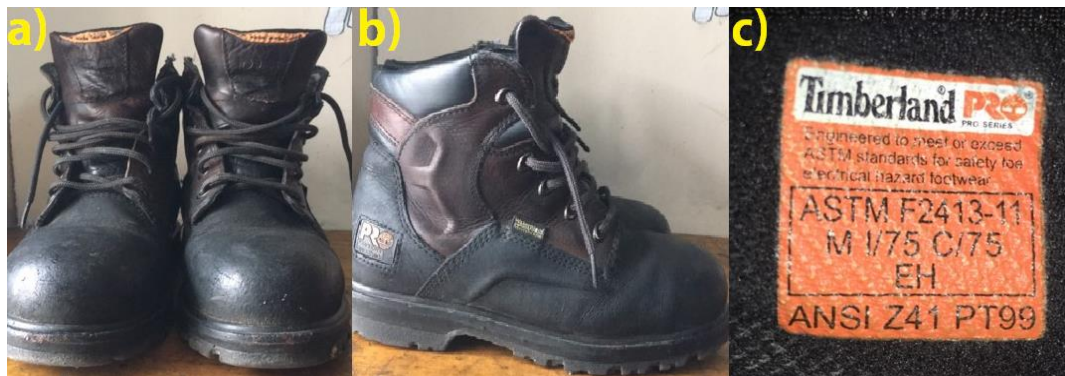
Figura 26. Calzado dieléctrico de medio uso (2) Timberland PRO: a) Vista frontal, b) Vista lateral y c) Etiqueta ASTM.
