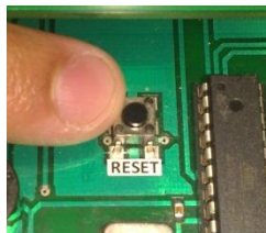
Figura 3-91 Botón Reset de la tarjeta de expansión
