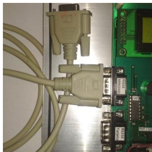
Figura 3-87 Conexión del cable en el puerto RS232 MINI2440
