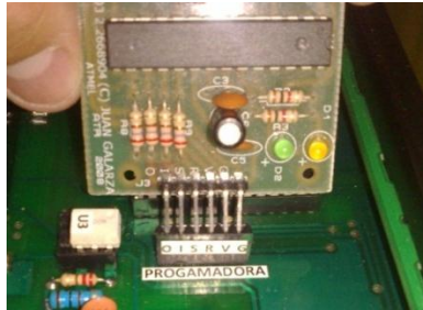
Figura 3-90 Conector de la programadora ATMEL
