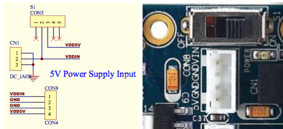
Figura 3-48 CON8 Conector para fuente de alimentación externa
