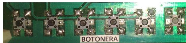
Figura 3-92 Botonera de la tarjeta de expansión
