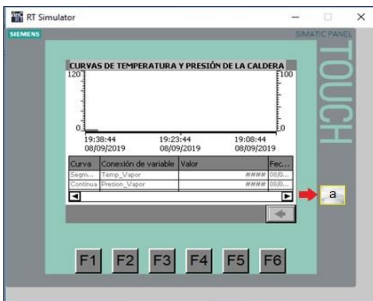
Figura 84. Pantalla de curvas de temperatura y presión de la caldera
