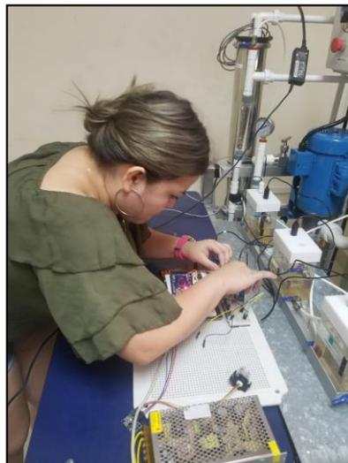
Imagen 13: Conexión de arduino con los medidores de ph y conductividad
