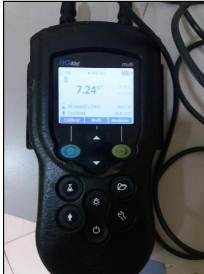
Figura 4.13 Datos de pH en tanque de agua de ingreso
