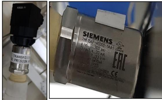
Figura 2.15 Transmisor de presión 7MF1567
