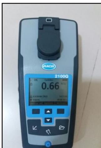
Figura 4.12 Muestra de valor de turbidez en tanque de agua de ingreso
