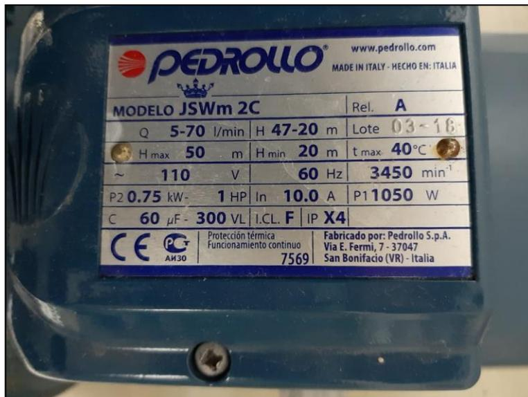
Imagen 1: Placa de la bomba centrífuga
