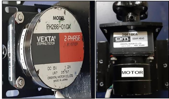
Imagen 5: Motor de pasos con caja reductora
