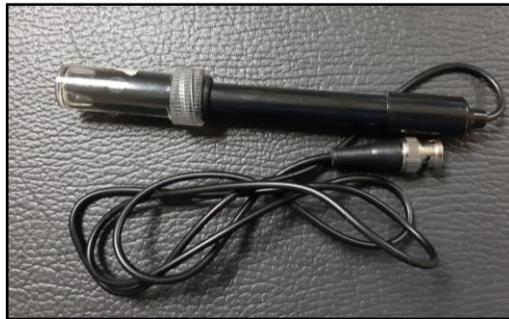
Figura 2.10 Sensor de PH SPH0001
