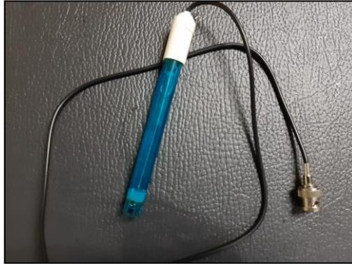
Imagen 7: Sonda electrodo de ph / Ph metro
