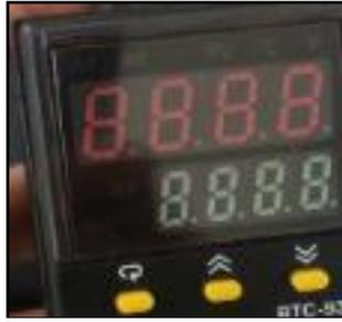
Figura 2.18 Controlador de temperatura BTC-9300
