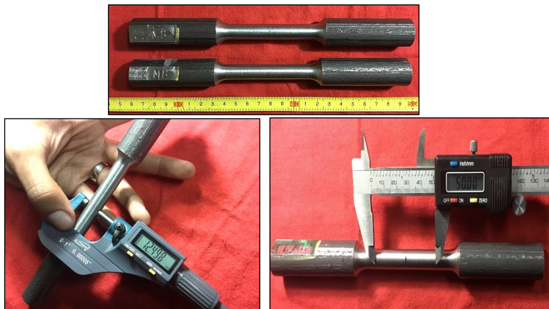
Figura 30. Control dimensional de las probetas de tracción Elaborado por: Jeferson Carvajal & Juan Garzón
