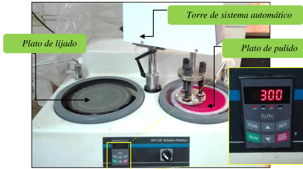
Figura 13. Pulidora de probetas metalográficas. Elaborado por: Jeferson Carvajal & Juan Garzón
