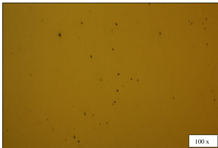
Figura 60. Inclusiones del acero AISI 4140 revenido a 590°C Elaborado por: Jeferson Carvajal & Juan Garzón
