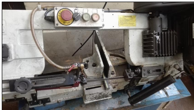
Figura 23. Cortadora de cinta automática, método de corte en frío Elaborado por: Jeferson Carvajal & Juan Garzón
