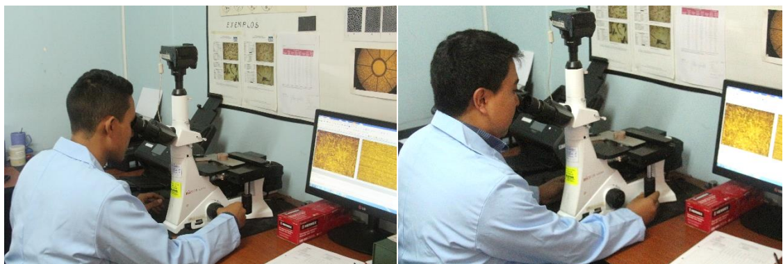
Figura 38. Implementación de equipo para análisis micro estructural Elaborado por: Jeferson Carvajal & Juan Garzón
