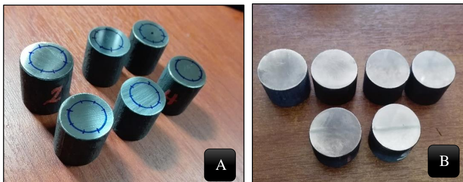
Figura 24. Probetas para ensayos de dureza (A) y metalografía (B) Elaborado por: Jeferson Carvajal & Juan Garzón
