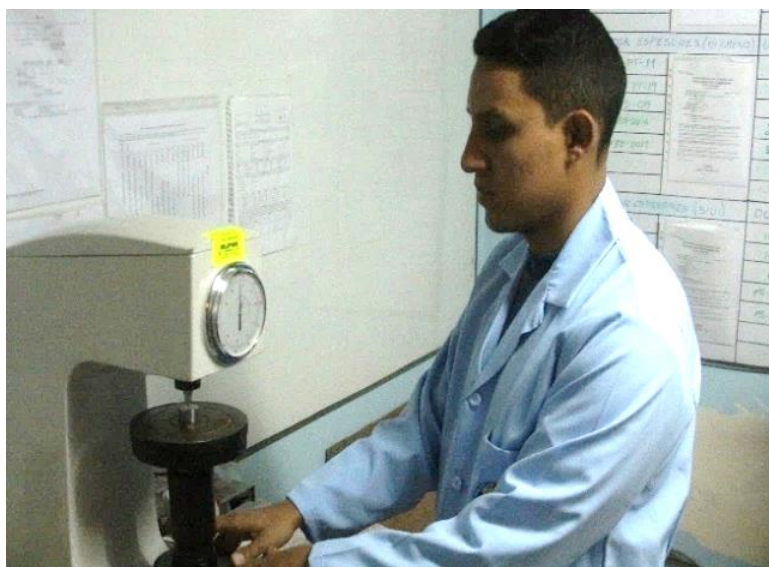
Figura 28. Durómetro de banco propiedad de ILPM Cia. Ltda Elaborado por: Jeferson Carvajal & Juan Garzón
