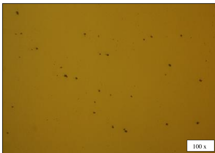
Figura 42. Inclusiones acero AISI/SAE 4140 bonificado Elaborado por: Jeferson Carvajal & Juan Garzón
