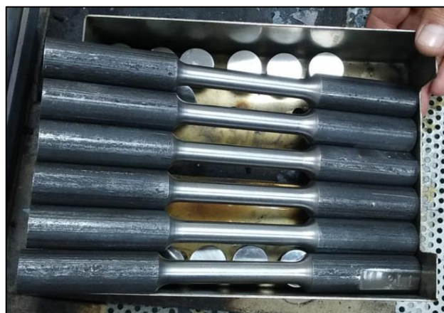
Figura 22. Probetas de tracción para tratamiento térmico. Elaborado por: Jeferson Carvajal & Juan Garzón
