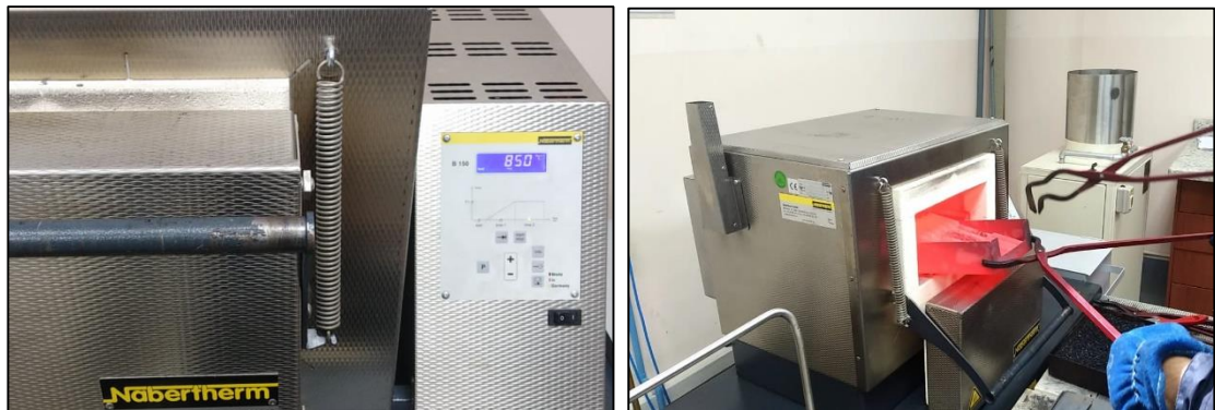
Figura 45. Detalle del tratamiento térmico de temple Elaborado por: Jeferson Carvajal & Juan Garzón
