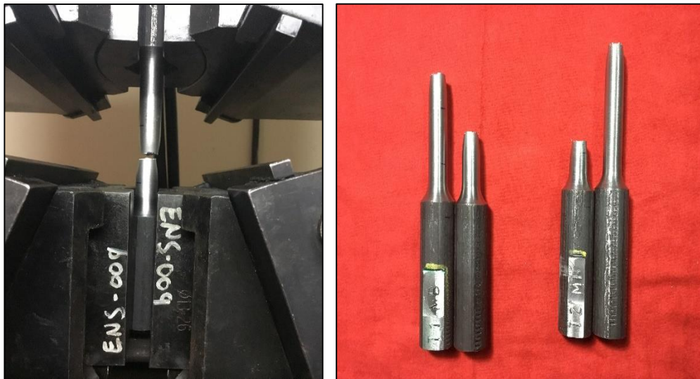
Figura 32. Proceso de rotura de las muestras de acero AISI/4140 bonificado. Elaborado por: Jeferson Carvajal & Juan Garzón
