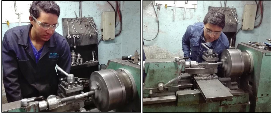
Figura 21. Maquinado de probetas de tracción. Elaborado por: Jeferson Carvajal & Juan Garzón
