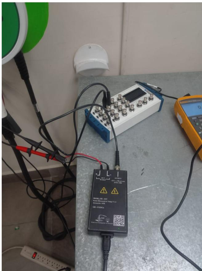
**Figura 3.2:** DAQ NI-USB-6216BNC utilizada en las mediciones de campo donde se observa el sensor de voltaje diferencial
