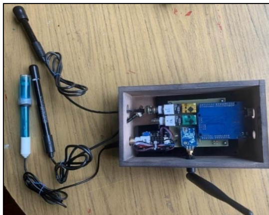
Figura 4-5 Composición del nodo sensor de pH, conductividad y OD. Fuente: Autores
