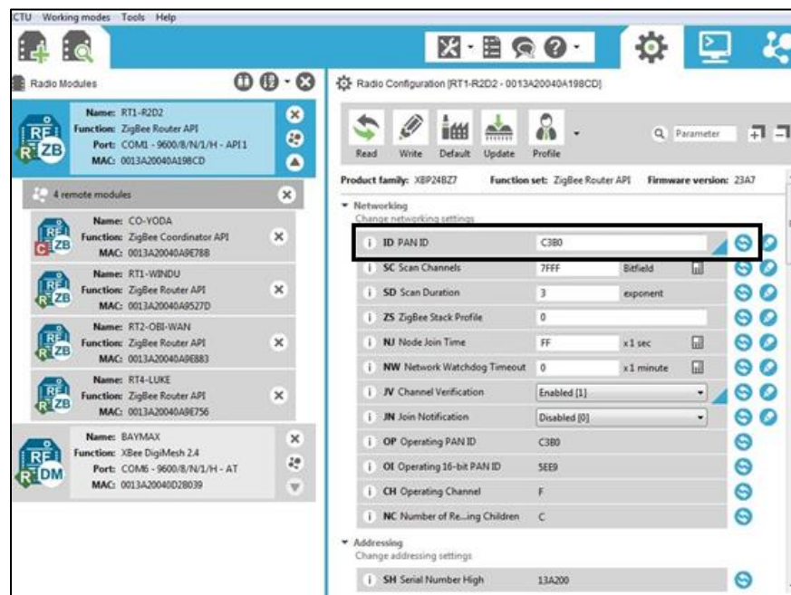
Figura 4-3 Configuración de nodo de muestreo Fuente: Autores
