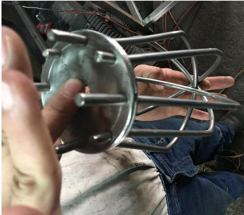
**Figura 48.** Construcción del batidor
