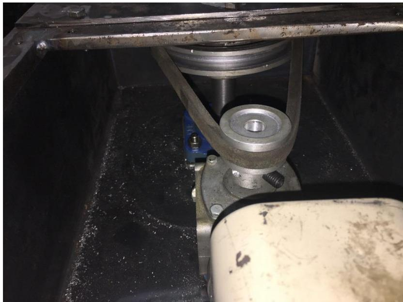
**Figura 49.** Construcción sistema de transmisión de potencia
