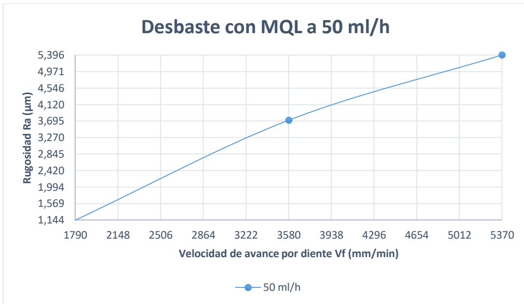
Figura 36. Acabado superficial en desbaste con MQL a 50 ml/h.
