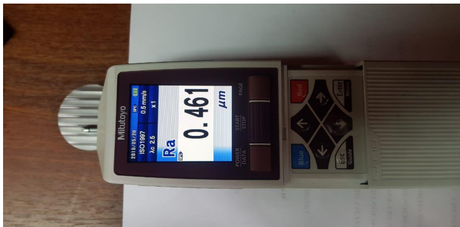
Figura 34. Toma de medidas de rugosidad para acabado (Probetas). Elaborado por: Sebastián Nicolalde & Mario Tutillo
