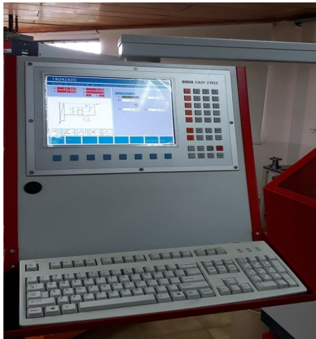
Fotografía 3. Elaboración del programa cilindrado para el maquinado en torno de probetas. Elaborado por: Sebastián Nicolalde & Mario Tutillo
