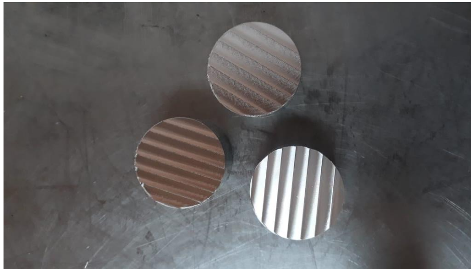
Figura 35. Acabado superficial de probetas mecanizadas con diferentes sistemas de lubricación.
