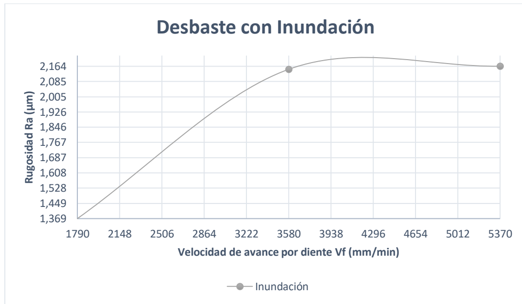
Figura 38. Acabado superficial en desbaste con sistema por inundación.
