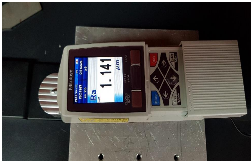
Figura 33. Toma de medidas de rugosidad para desbaste (Probetas). Elaborado por: Sebastián Nicolalde & Mario Tutillo
