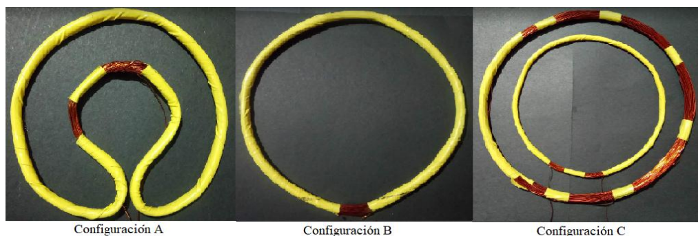
Figura 4.1 Tipos de bobinas para el detector de metales
