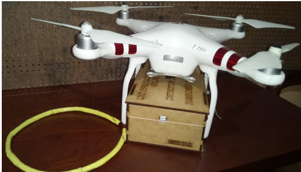
Figura 3.4 Implementación del detector de metales en el drone
