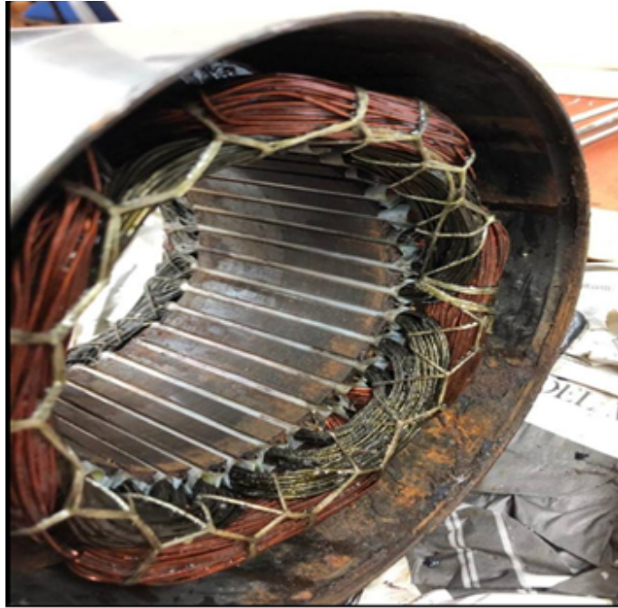
Figura 3.10.: Bobinado de máquina original (detalle del estator)
