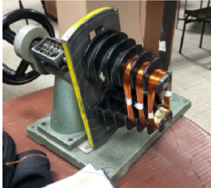
Figura 5.2.: Fabricación de las bobinas de arranque
