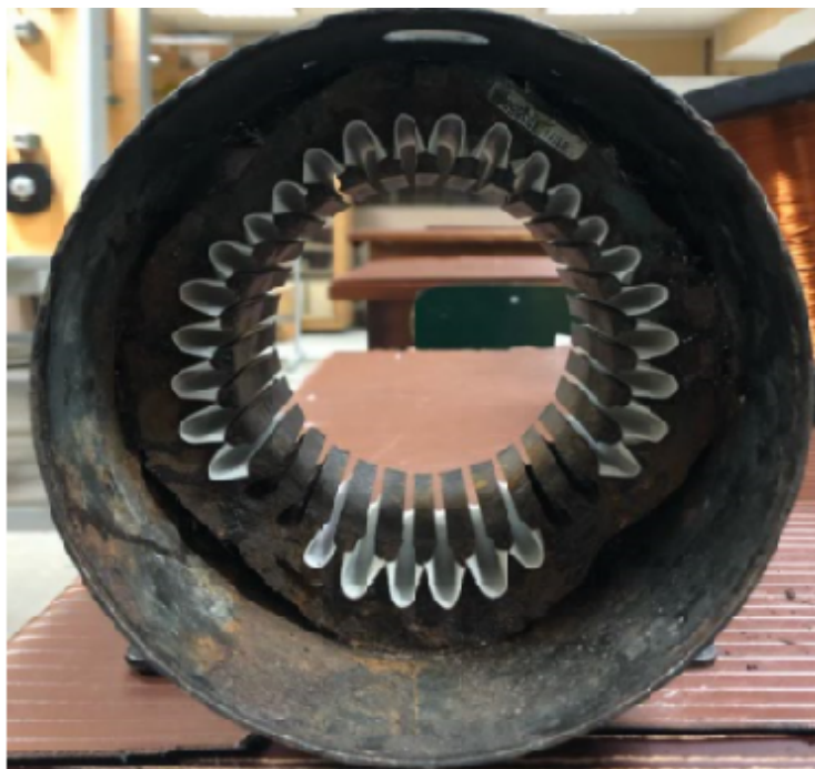
Figura 5.3.: Láminas aislantes en las ranuras del estator
