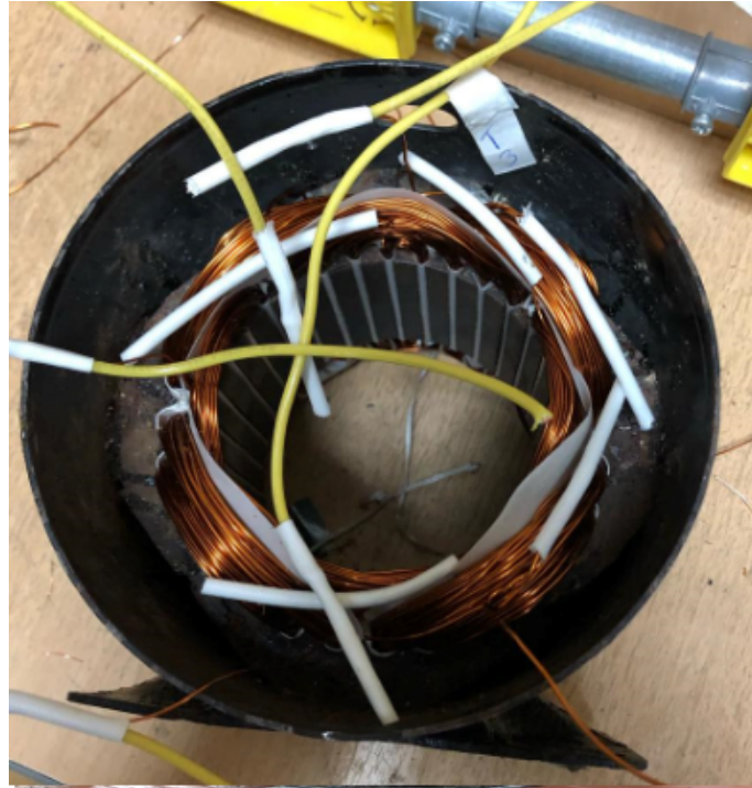
Figura 5.5.: Conexión de las diferentes bobinas y salidas de los devanados
