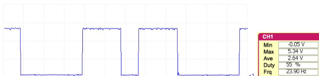
Figura 17. Señal del sensor CMP. Fuente: UPS
