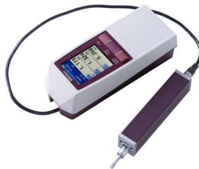
Figura 16. Rugosímetro MITUTOYO SJ 210 [22]
