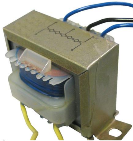
Figura B.1 Transformador reductor.
