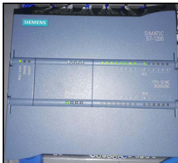
FIGURA 26. PLC SIEMENS S7-1200. FUENTE: LOS AUTORES
