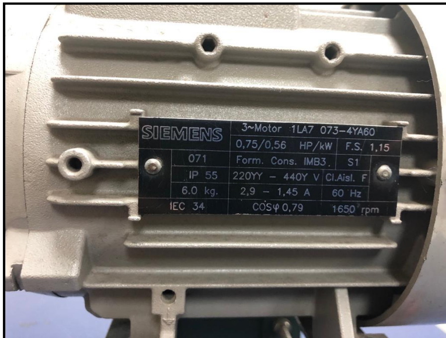
FIGURA 54. MOTOR TRIFÁSICO Y SUS DATOS DE PLACA.
