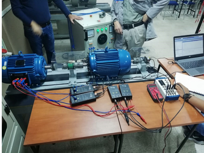
Figura 4.2: Conexión de los Instrumentos para la Adquisición de Datos
