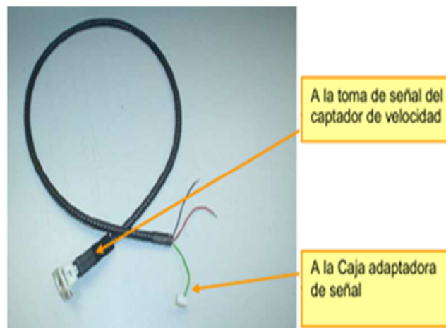
Fig. 1.11.6 Conector del taxímetro. Fuente: Manual para programar e instalar el taxímetro/ Taxímetro TAXSYM 09.
