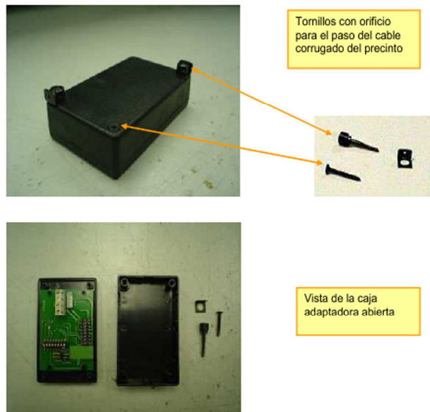
Fig. 1.11.9 Descripción de la Caja adaptadora de Señal (Conversor-Adaptador). Fuente: Informe de homologación para taxi del vehículo Citroën C8.
