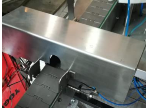
Figura 3.18 Estructura metálica para control de calidad
