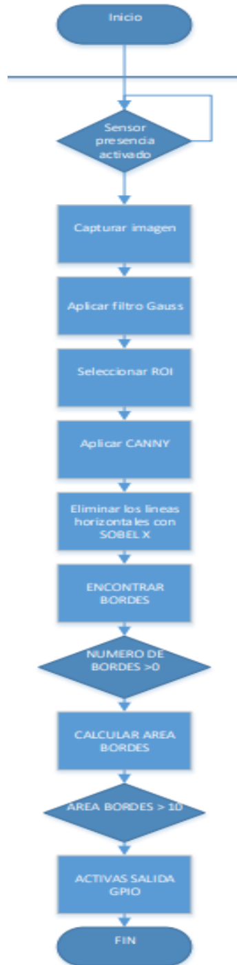
Diagrama de flujo algoritmo subsistema control de calidad, Elaborado por: Geovanny Cumbal & Jorge Villa
