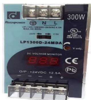
Figura 3.21 Fuente de alimentación EBCHQ LP1300D-24MDA
