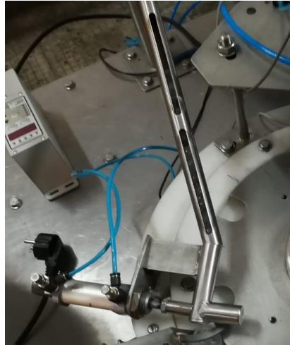
Figura 3.6 Carrilera de alimentación bola dosificadora
