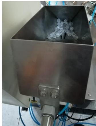
Figura 3.5 Tolva de alimentación bola dosificadora
