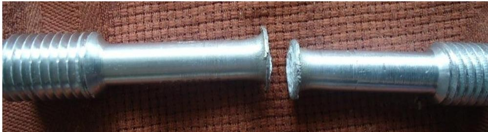
**FIG. 4.10. ENSAYO DE RESISTENCIA A LA TRACCIÓN DESPUÉS DE LA SOLDADURA DEL ALUMINIO
