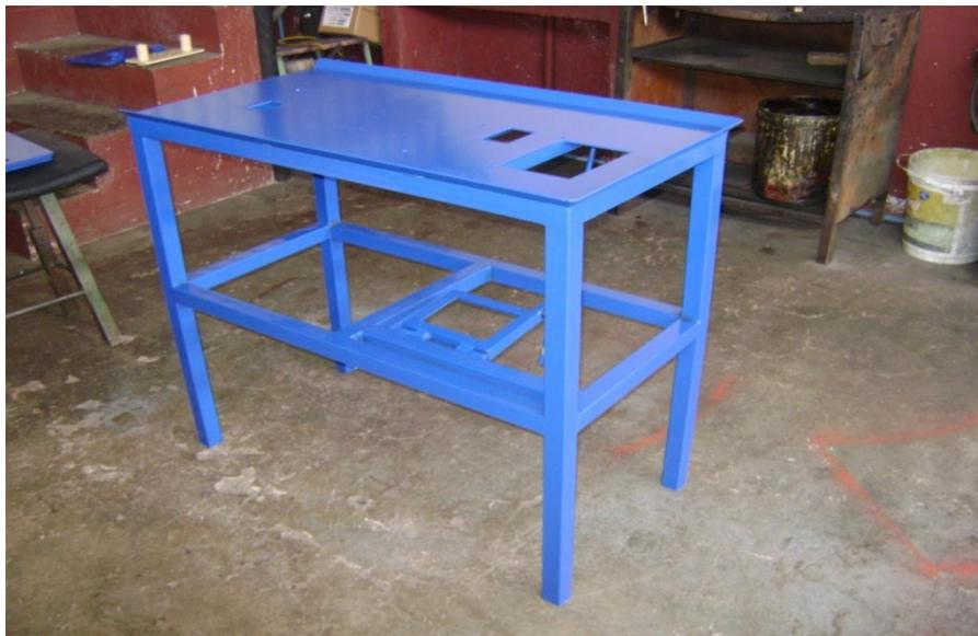
**FIG.A4.2 BANCADA DEL EQUIPO DE SOLDADURA**
