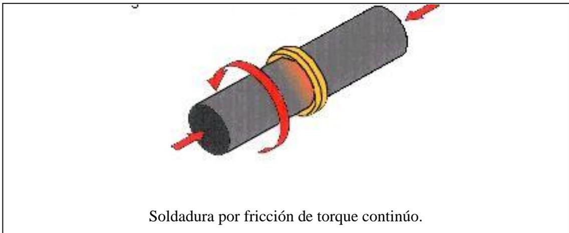
Este tipo de máquina soldadora por fricción de torque continuo trabaja bajo los siguientes parámetros:
