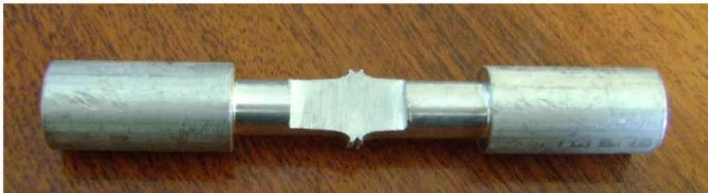
**FIG. 4.8. PROBETA DE ALUMINIO DE 12 mm**
