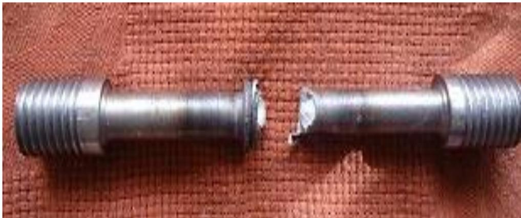
**FIG. 4.4 ENSAYO DE RESISTENCIA A LA TRACCION DESPUES DE LA SOLDADURA
