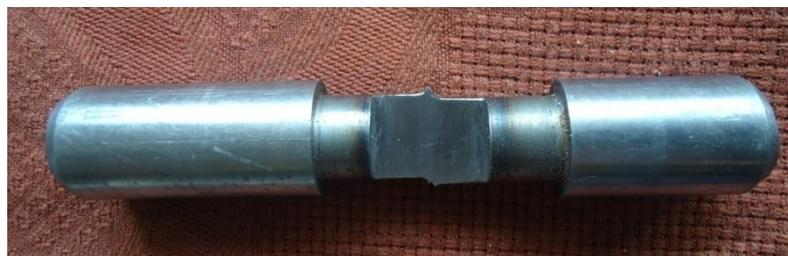
**FIG. 4.2 PROBETA DE ACERO 12 mm**
