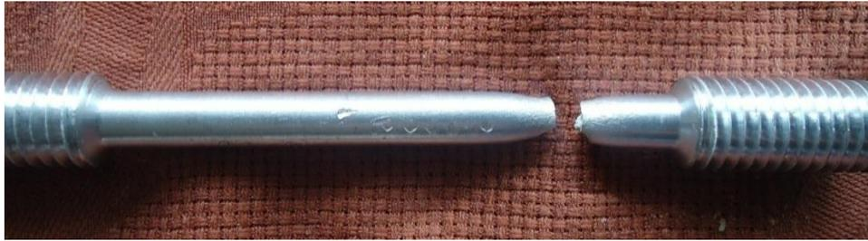
**FIG. 4. 9 ENSAYO DE RESISTENCIA A LA TRACCIÓN ANTES DE LA SOLDADURA DEL ALUMINIO
