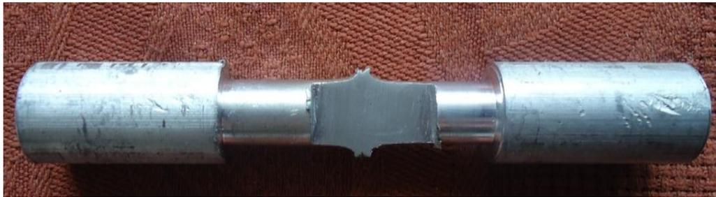
**FIG. 4.7. PROBETA DE ALUMINIO DE 10 mm**
