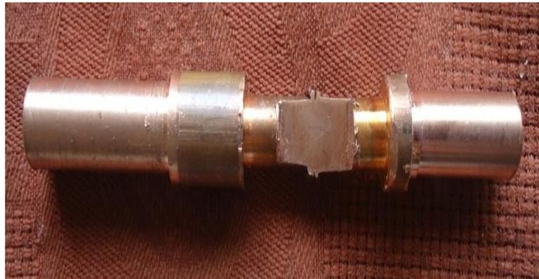
**FIG. 4.5 PROBETA DE COBRE DE 10 mm**
