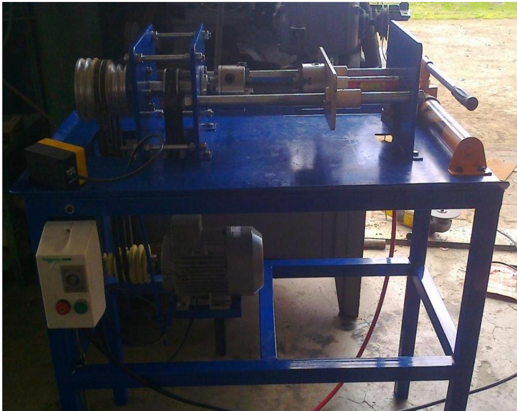
**FIG. A4.12 EQUIPO DE SOLDADURA POR FRICCIÓN DE TORQUE CONTINUO**
