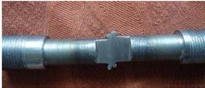
**FIG. 4.1 PROBETA DE ACERO DE 10 mm**
