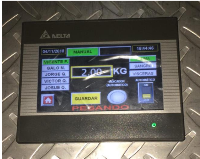
Figura 38: Visualización de un peso 2 kg en el HMI.
