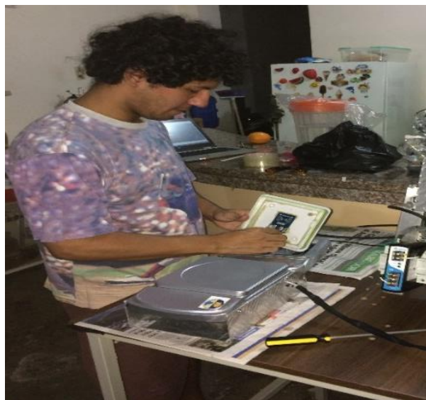
Figura 24: Instalación de módulo RFID (antena).
