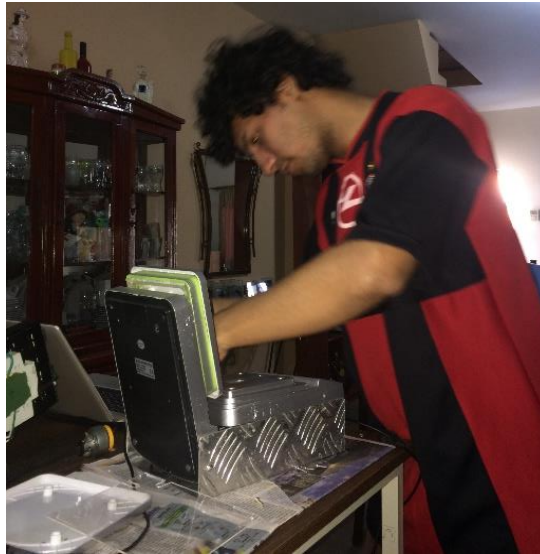
Figura 27: Estructura que contiene balanza y módulo RFID.
