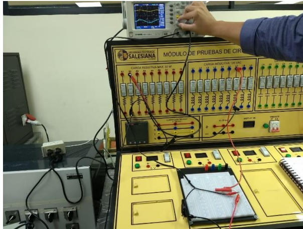
FIGURA 44. FILTRO PASA-BAJO R-L IMPLEMENTADO EN MÓDULO DE PRUEBAS.
