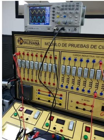
FIGURA 62. FILTRO PASA-ALTO R-L IMPLEMENTADO EN MÓDULO DE PRUEBAS.
