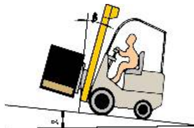
Figura 1.3 Circulación por rampas.
