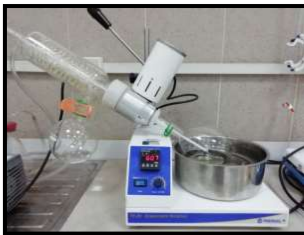
Figura 19. Extracto macerado de la pulpa en el Rotavapor
