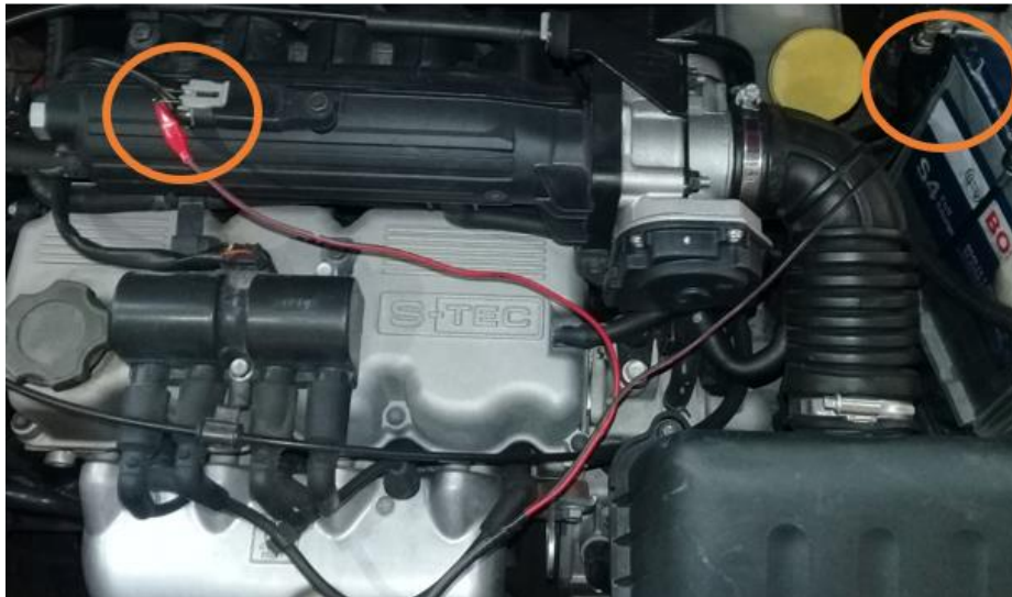
Figura 11. Conexión para adquisición de datos sensor MAP.
