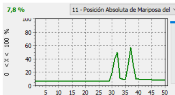
Figura 19. Señal obtenida del TPS, eje Y: porcentaje de apertura del sensor, eje X: Tiempo.
