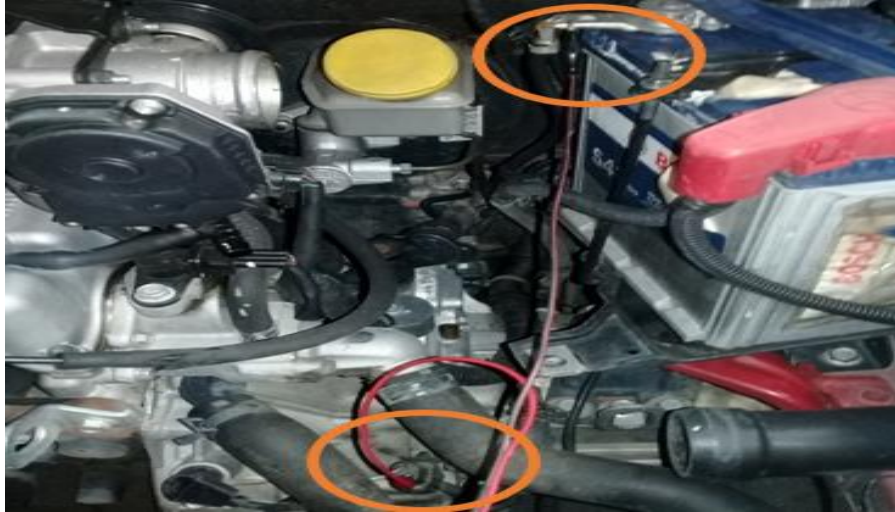
Figura 15. Conexión para adquisición de datos de sensor de Oxígeno.
