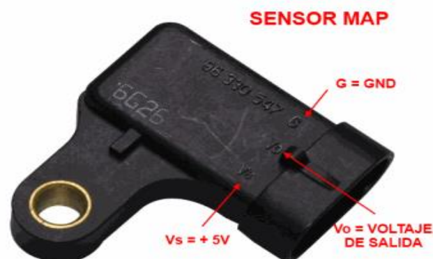
Figura 10. Disposición de pines del MAP (AutoDaewooSpark, 2018)
