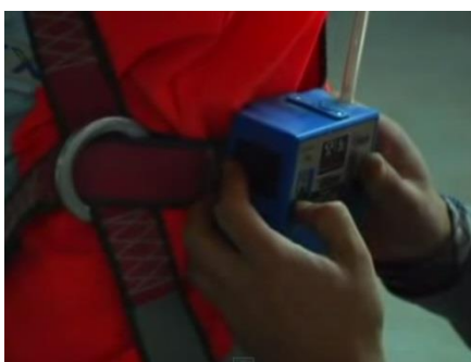
Figura 6. Instalación de filtro de cassette en soporte del ciclón Fuente: Empresa estudiada.
