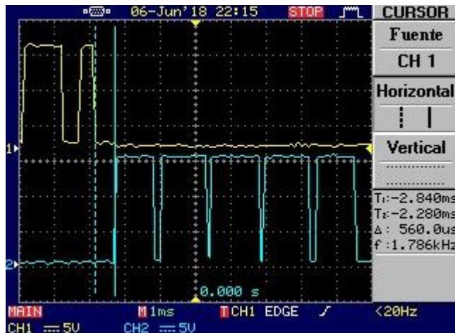
Figura 4.7. Tiempo muerto tomado entre las señales u+ y u-
