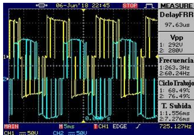
Figura 4.10. Señales trifásicas R (amarilla) y S (celeste) desfasadas 120°
