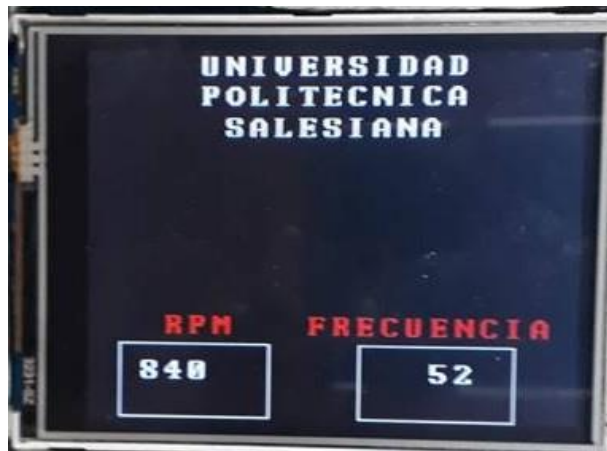
Figura 4.3. Interfaz gráfica con pantalla TFT
