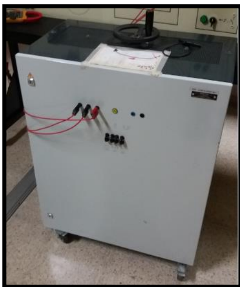
FIGURA 25: BANCO TRIFÁSICO INDUCTIVO DE 4KVAR
