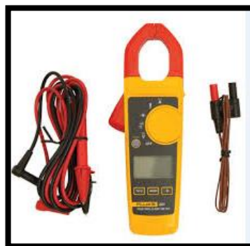
FIGURA 22: AMPERÍMETRO Y MULTÍMETRO FLUKE 323
