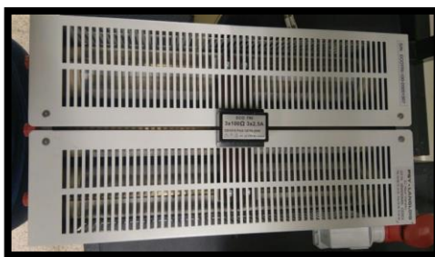
FIGURA 24: BANCO TRIFÁSICO RESISTIVO VARIABLE 0-100 \Omega , 2.5A
