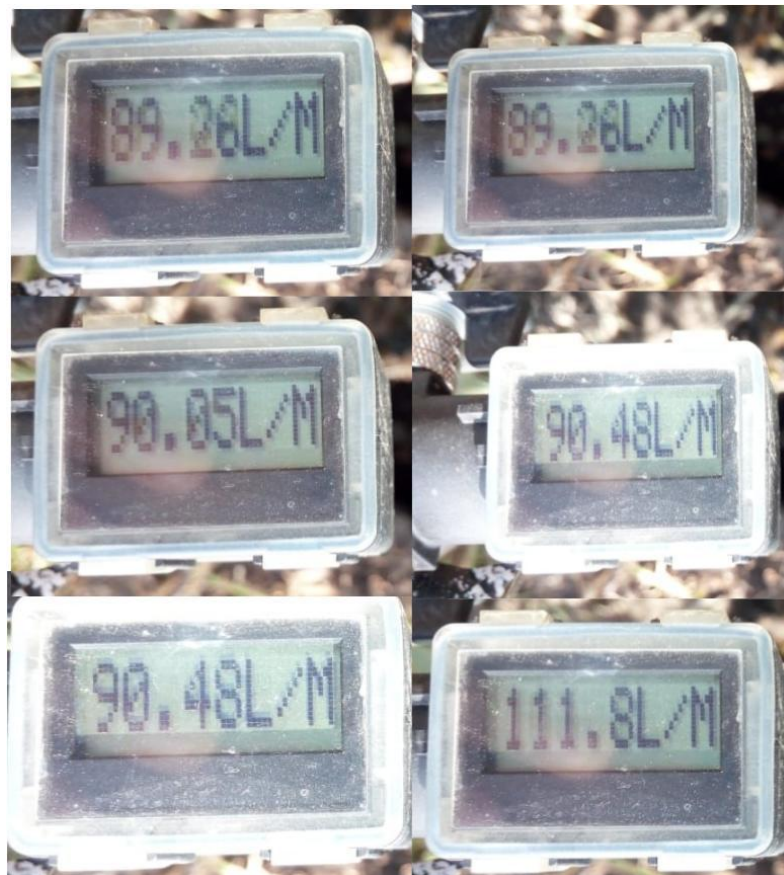
Obtención de datos mediante el caudalímetro LVB-25, comunidad Paquiestancia. Elaborado por: Carlos Campoverde y Andrés Gualoto
