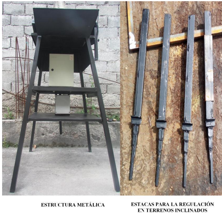
Figura 3.10. Estructura metálica con estacas
