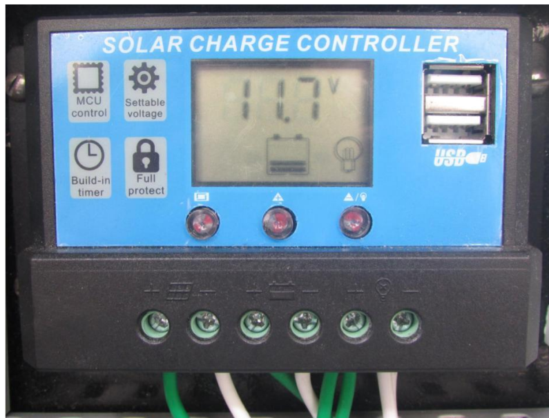
Figura 3.8. Regulador de carga CM20K
