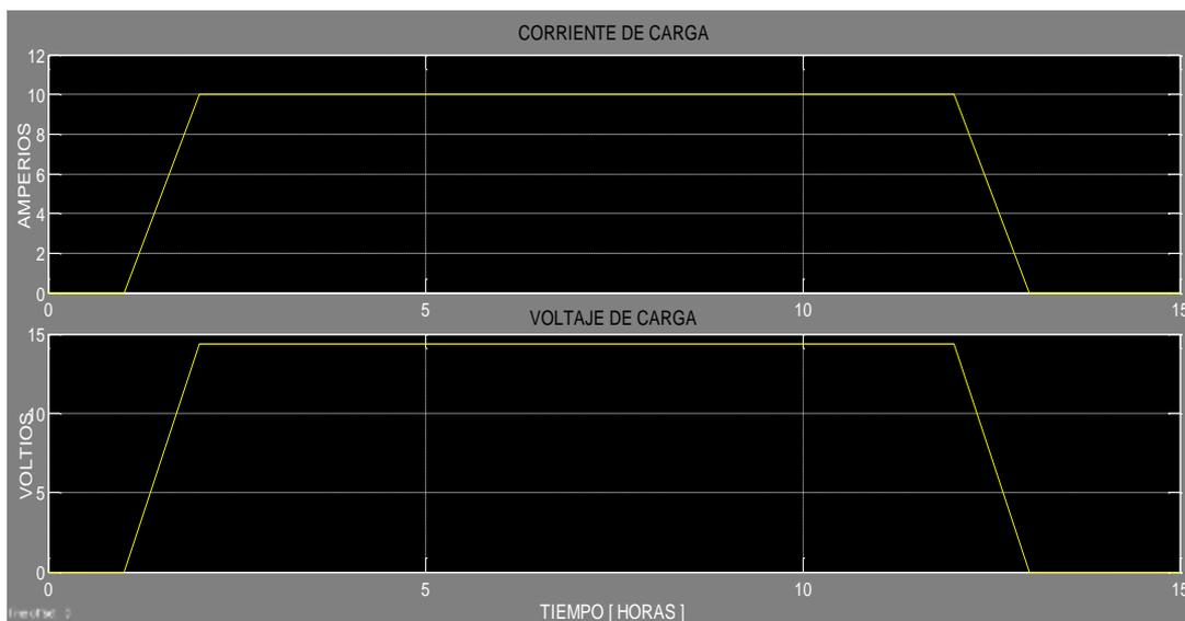
Figura 70: Corriente y voltaje regulado.
