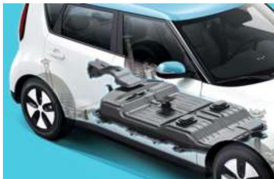
*Figura 6: Disposición de batería de alto voltaje.*
