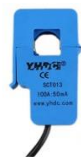
Figura 35. Sensor de corriente SCT-013-000 no invasivo.
