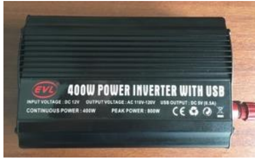
Figura 26. Inversor de voltaje entrada 12Vdc con salida a 115Vac
