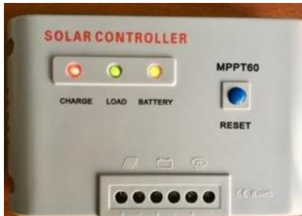
Figura 24. Regulador de carga en funcionamiento
