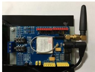
Figura 14. Módulo SIM900 GSM/GPRS (J. Ortiz, G. Valencia, 2018)
