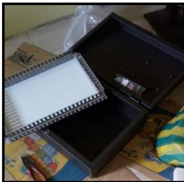
FIGURA 22: ESTRUCTURA METÁLICA DEL MÓDULO DIDÁCTICO DE AUTOMATIZACIÓN
