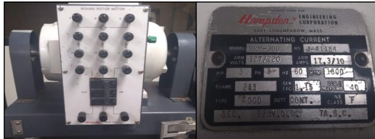
FIGURA N° 13: MOTOR TRIFÁSICO HAMPDEN WRM-300
