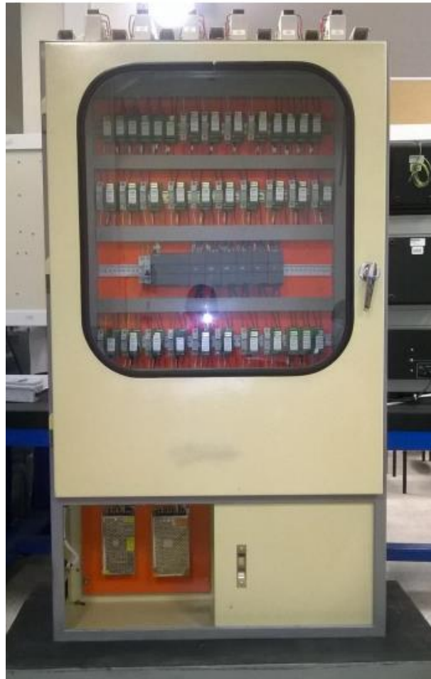
FIGURA N° 18: MÓDULO DE ADQUISICIÓN Y PROCESAMIENTO DE PARÁMETROS ELECTROMECÁNICOS PARA EL LABORATORIO DE MOTORES Y GENERADORES
