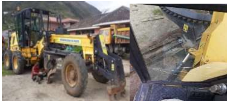
Figura 24. Motoniveladora New Holland RG140B Fuente: Autores
